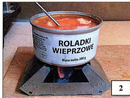
Rys. 8. Badania skuteczności podgrzewania zawartości konserw 1- podgrzewanie zestawem odniesienia, 2 – podgrzewanie zestawem FireDragon
